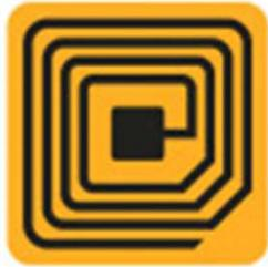
Tag RFID composé d'une puce électronique associée à une antenne
