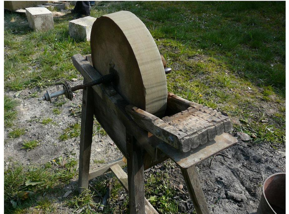
Meule sur chassis en bois, actionnée par une manivelle, pour l'affutage des outils.
