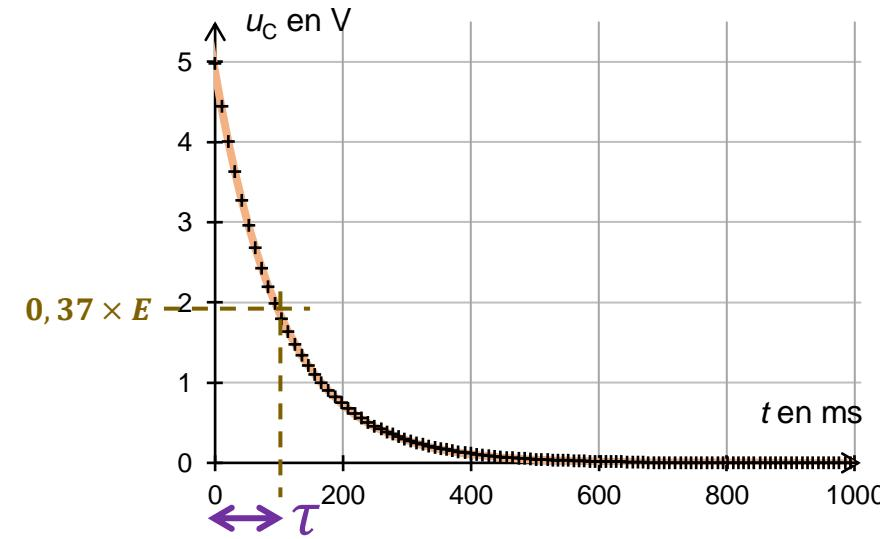
La constante de temps  $R \cdot C$  est un temps caractéristique des phénomènes de charge et de décharge du condensateur.
